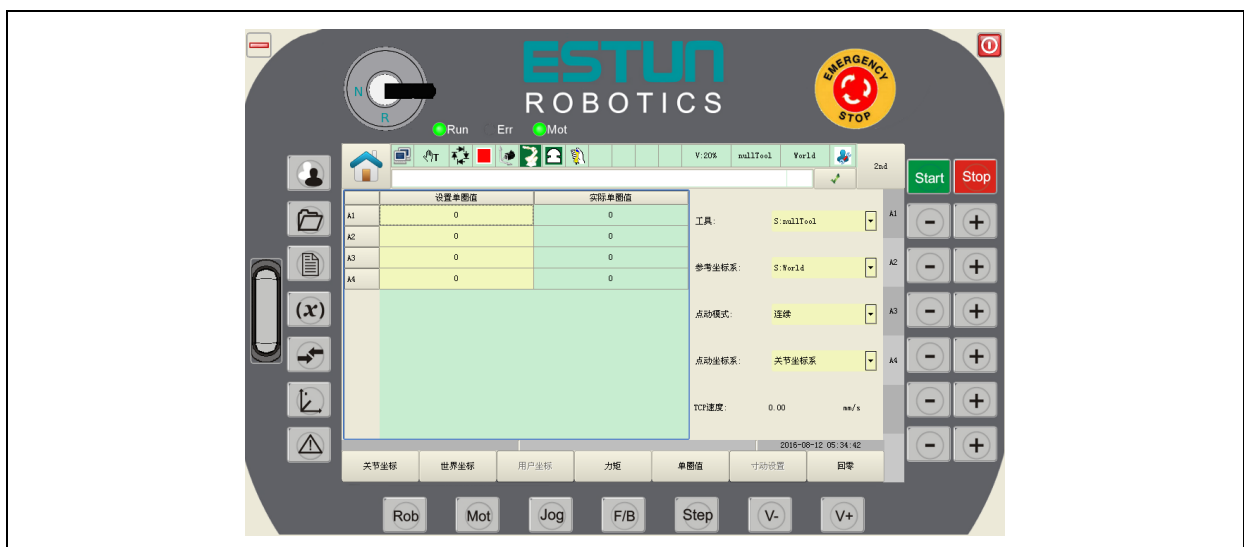
图 6.1 快速零位校准单圈值信息（ERC 控制器）
