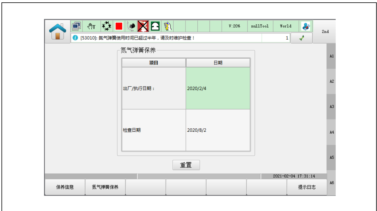
图 5.4 气弹簧检查软件提醒示意图
